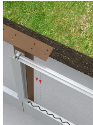
Desarrollado para permitir el acoplamiento de la primera hilada de traviesas de pared, el perfil de aluminio se apoya en la parte superior de los paneles de estructura base. Haga deslizar el perfil de aluminio en la cavidad del pilar hasta la parte superior del panel.
