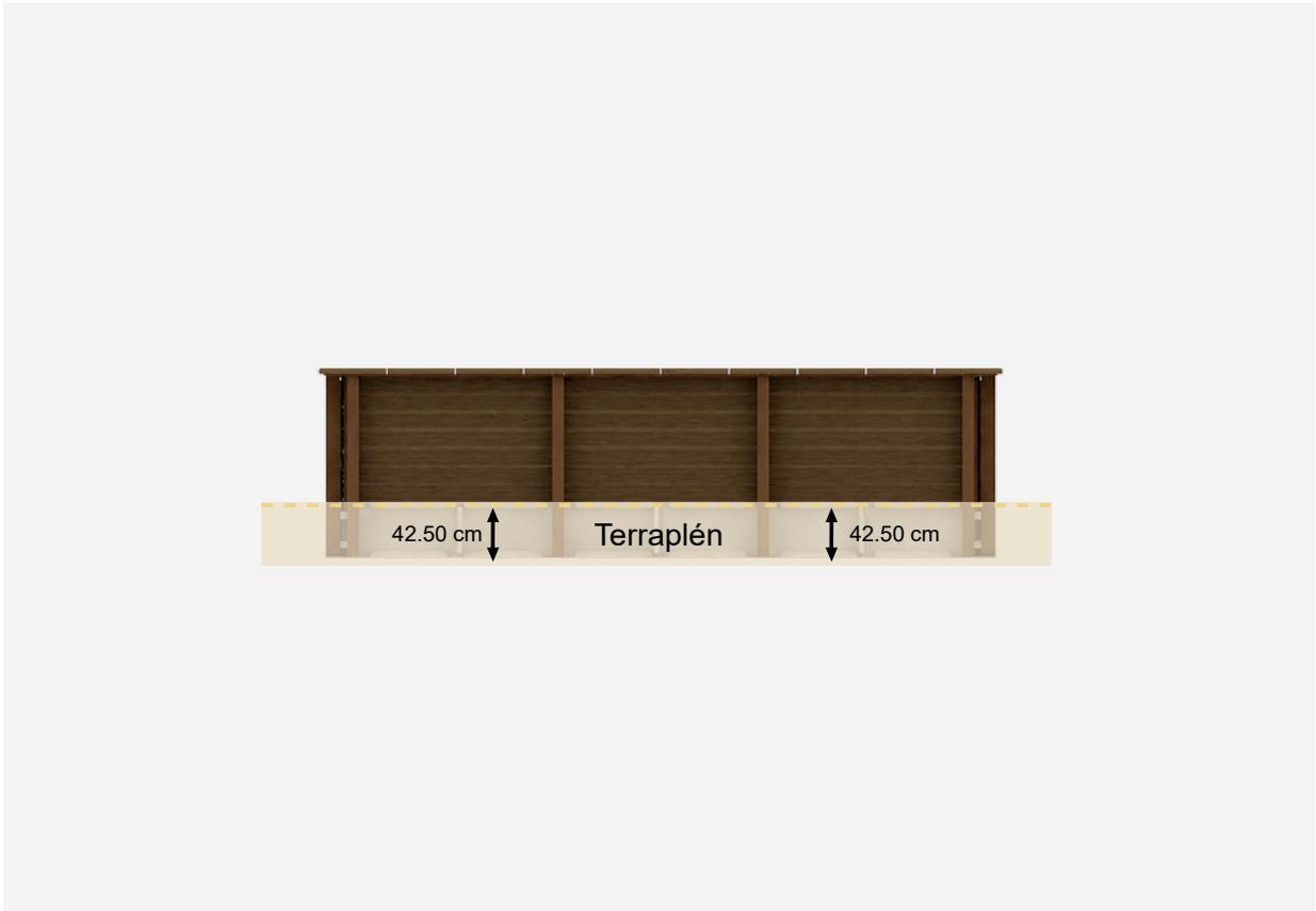
A continuación, realice el relleno hasta que la estructura base de acero quede completamente cubierta (aproximadamente 42.50 cm).
