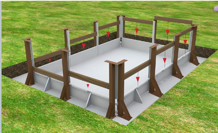
Una vez colocada la primera fila de traviesas certifique que estan debidamente encajadas para garantizar que el perfecto montaje del resto de la estructura.
