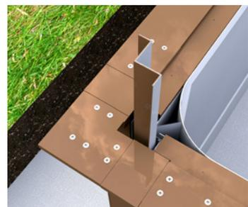
En las 4 esquinas de la piscina se efectúa la colocación de la esquinera W de conformidad con lo demostrado en las imágenes.
