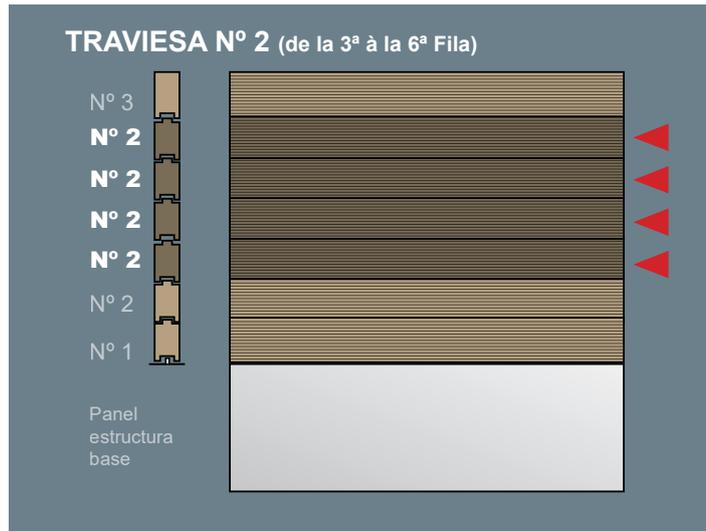
La travesa n° 2 se destina a la construcción del muro de la piscina, desde la 2ª a la 6ª fila, con la excepción de la pared donde será instalado el equipamiento de filtración. En esta pared las traviesas irán solamente hasta la 3ª fila. Esta colocación del Skimfiltro y de la boquilla de impulsión serán abordados en los siguientes capítulos.
