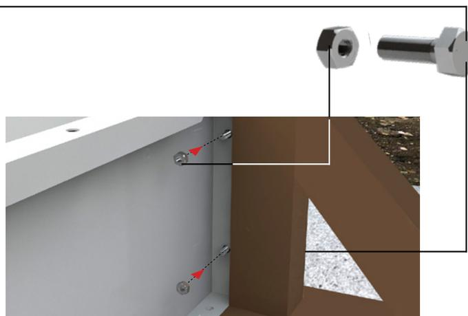
A continuación proceda a la colocación del siguiente panel y realice la respectiva fijación con los tornillos que encuentra en el kit de tuercas y tornillos.
