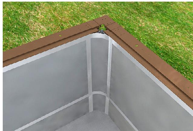
La esquina R15 se instala en las esquineras de la piscina entre la esquina W anteriormente colocada y los perfiles de los pilares.
