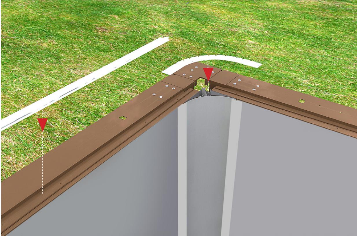
Comience por aplicar una línea de silicona sobre el soporte de metal del borde. Coloque el conjunto de perfiles hung de fijación que le disponibilizamos en el soporte de metal del borde, localizado en el interior de la piscina y recorriendo de la ayuda de un destornillador aplique los tornillos autoperforantes de 20 en 20cm.
