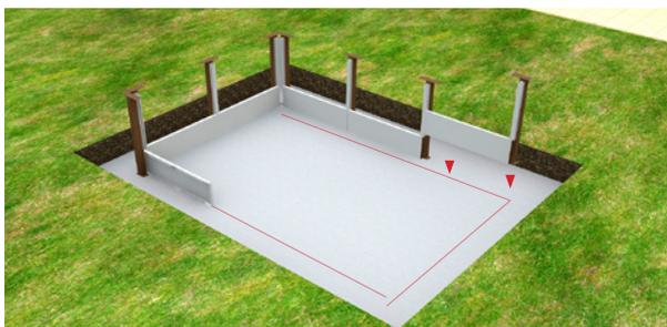
A continuación, repita el mismo procedimiento hasta obtener la forma completa de la piscina. Antes de realizar la fijación a la losa de hormigón, compruebe las diagonales y la nivelación de la estructura.
