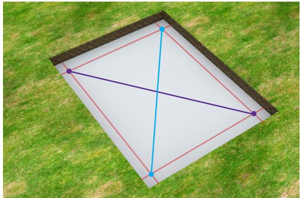
Confirme las diagonales para que correspondan con las medidas de 5,21m y de este modo obtendrá la forma para la instalación correcta de la piscina.
