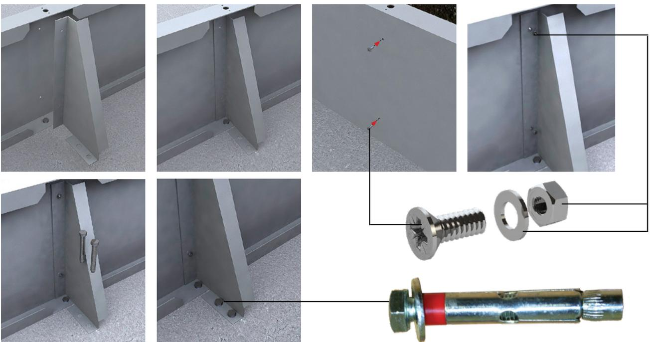
Coloque el refuerzo triangular en el panel, acertándolo por los agujeros existentes. Utilice los tornillos correspondientes y las tuercas para la fijación al panel. Para la fijación del refuerzo triangular utilice los bujes metálicos igualmente utilizados para la fijación del panel de estructura base.
