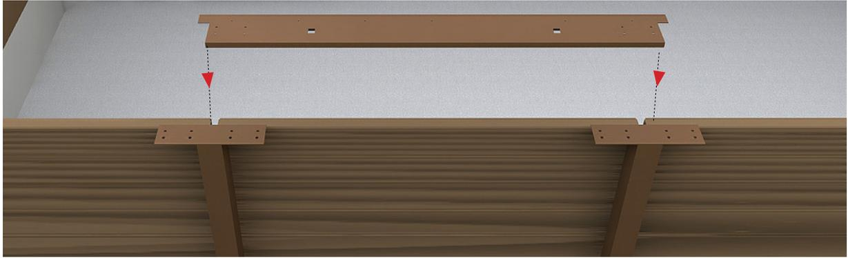
Los soportes de acero son fijados a través de las tuercas y de los tornillos disponibilizados en el kit (use solamente las herramientas adecuadas).
