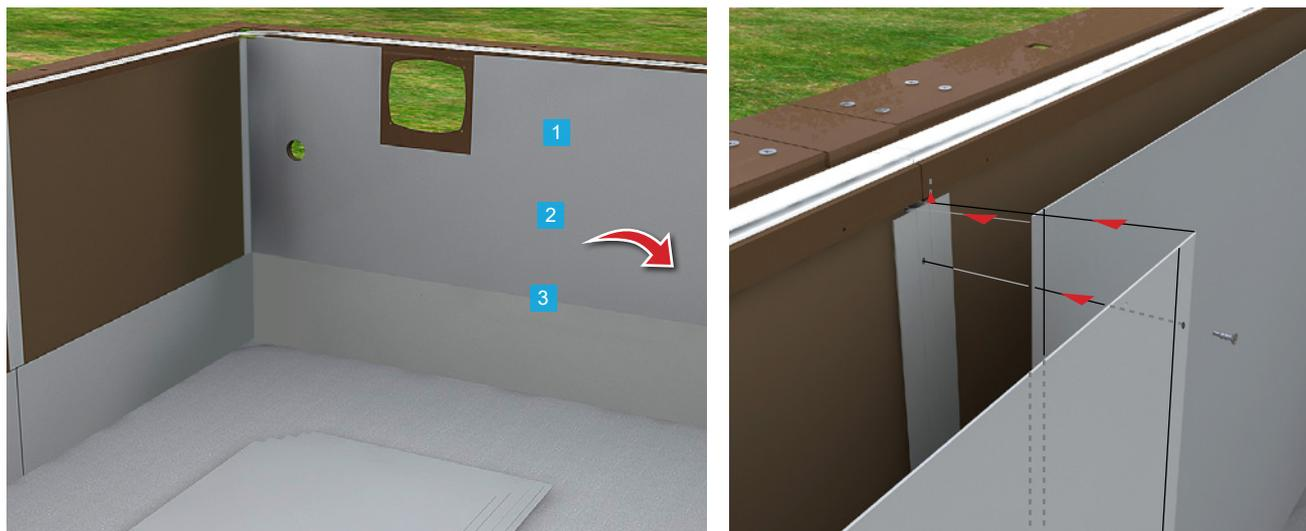
La fijación de los paneles de acero tiene inicio en la pared del skimmer. Posicione los paneles de acero haciendo que sus lados se superpongan aproximadamente 1,5cm. Coloque los tornillos auto perforantes en 3 puntos, en el medio del pilar y atornille los paneles, (siga como soporte las ilustraciones de montaje).
