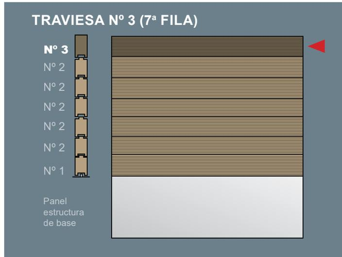
Las traviesas nº3 se destina a la ultima dila del muro de la piscina, con excepción de la pared para el equipamiento de filtración.
