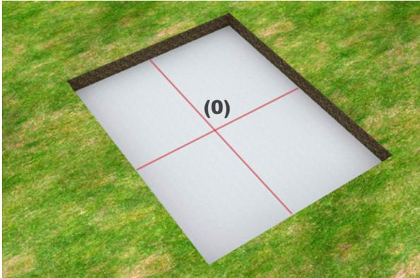
Encima de la losa de hormigón, marque el trazado de la piscina. En esta primera marcación encuentre el punto central de la losa en hormigón **(0)**.
