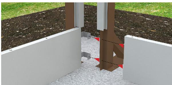
Después de fijar el primer panel de estructura base al pilar de la esquina proceda a la colocación del pilar recto que completa la esquina de la piscina.
