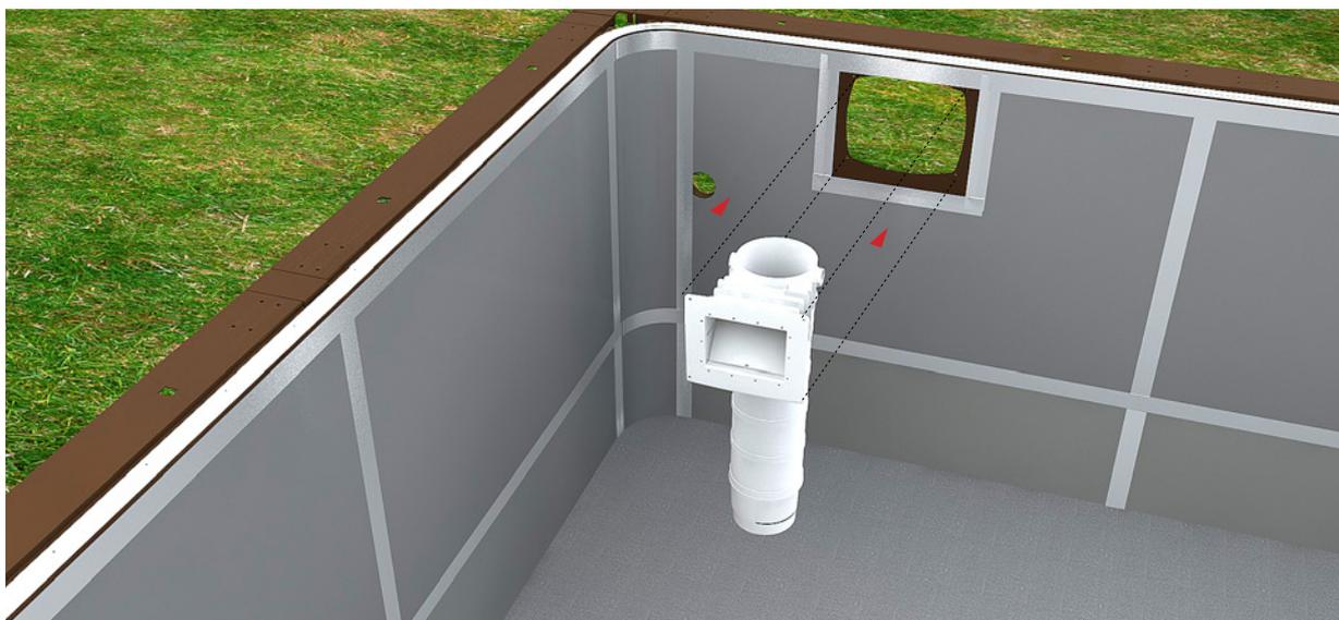
El skimfiltro esta instalado en el panel de metal cortado para esse efecto. Para facilitar el transporte y la colocación, el skimfiltro viene dividido en dos partes:
