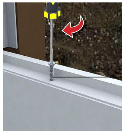
Después de colocar el perfil de aluminio en el panel de estructura base, será visible que la perforación del perfil este alineada con las perforaciones existente en la parte superior del panel. Utilice estas perforaciones para fijar el perfil a la estructura base utilizando los tornillos suministrados en el kit.
