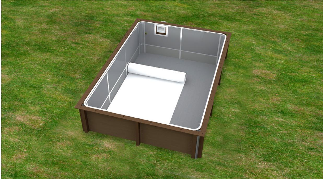
Proceda a la colocación de las diferentes piezas y realice los cortes necesarios en la alfombra geotextil para obtener la forma y la dimensión correspondiente a la piscina.
