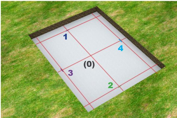
A partir de los puntos **3** y **4** marque dos líneas paralelas a 1/2 sobre toda la longitud de la losa de hormigón.
