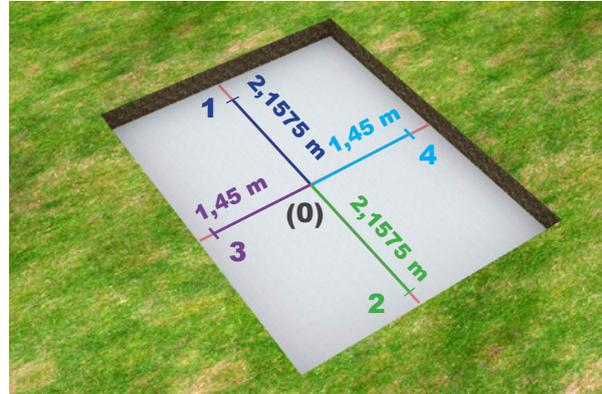
Elabore la marcación de los puntos **1** y **2** apartados 2,1575m del centro de la piscina **(0)**. Repita la operación para obtener los puntos 3 y 4 a una distancia de 1,45m del centro de la piscina **(0)**.
