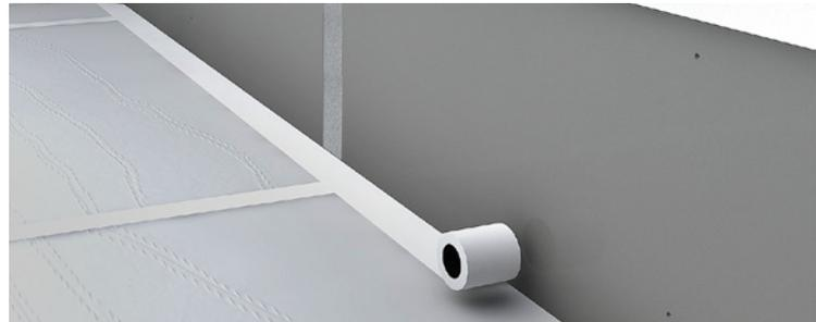
En seguida, coloque las diferentes piezas, bien alargadas, en el fondo de la piscina, sin que las mismas se sobrepongan y termine con la aplicación de la cinta adhesiva sobre las uniones de los diferentes elementos. También aplique la cinta adhesiva alrededor de la piscina sobre la alfombra y la pared de acero.
