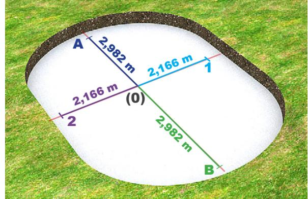
Elabore la marcación de los puntos **A** y **B** apartados 2,982m del centro de la piscina (0). Repita la operación para obtener los puntos 1 y 2 a una distancia de 2,166m del centro de la piscina (0)
