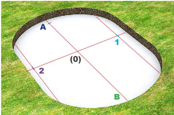
A partir de los puntos **1** Y **2** marque dos líneas paralelas a A/B sobre toda la longitud de la losa de hormigón.
