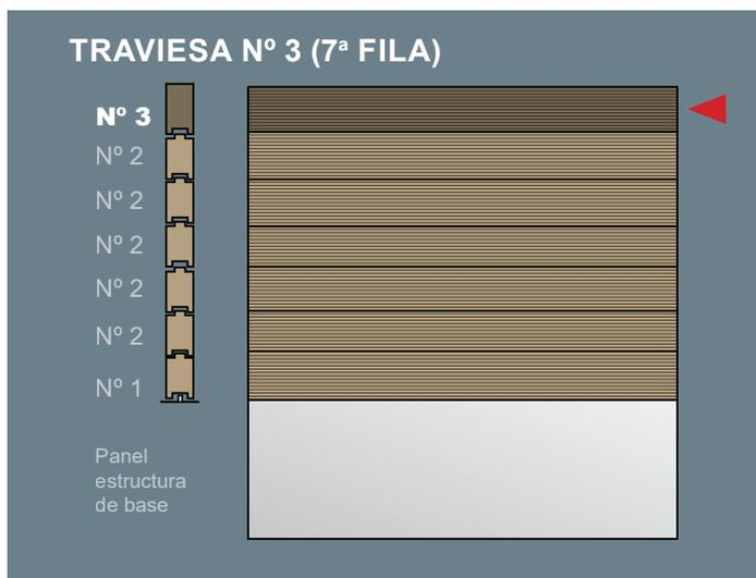
Las traviesas nº3 se destina a la ultima dila del muro de la piscina, con excepción de la pared para el equipamiento de filtración.
