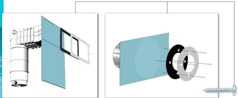
Luego sobreponga el sello y la brida de los accesorios uno sobre el otro y haga el primer agujero, fijando el primer tornillo. Después de hacer el segundo atornillamiento, todos los otros deberán estar posicionados correctamente.
