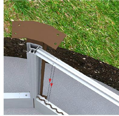
Desarrollado para permitir un encaje de la primera fila de traviesas de pared, el perfil de aluminio se instala en la parte superior de los paneles de la estructura base. Haga deslizar el perfil de aluminio desde el hueco del panel hasta arriba.
