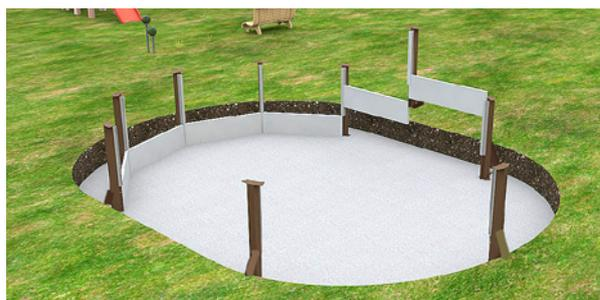
Para obtener la localización del pilar intermedio entre **C/D** e **E/F** coloque los dos paneles en la estructura de base.
