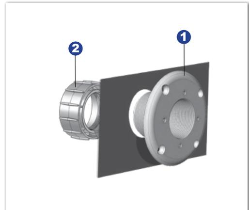
La boquilla de impulsión es colocada a través del interior de la piscina y con la face enroscada hacia afuera **(1)**. Por la parte externa atornille la tuerca**(2)**.
