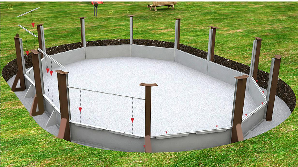
Proceda a la fijación de los perfiles usando todas las perforaciones para esse efecto y repita todo el procedimiento en el perímetro de la piscina.
