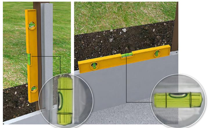
Después de definir el posicionamiento de los pilares y de la estructura base, consonante las indicaciones del plan, compruebe las indicaciones contenida en el plan y las dimensiones de las diagonales. La distancia entre los puntos **C/E** y **D/F** tendrá que ser de 5,167m.
