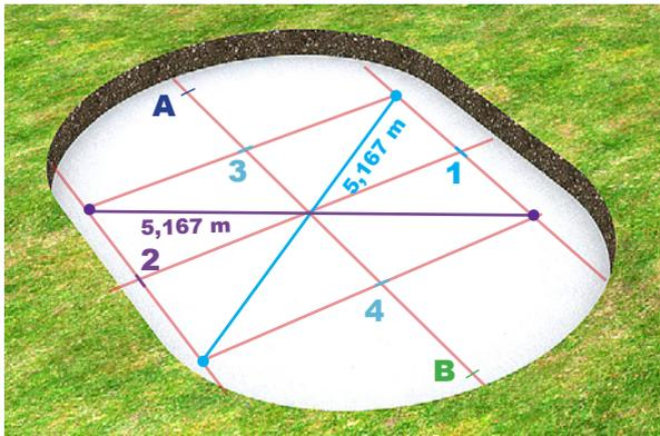
A partir de los puntos **3** e **4** señale dos líneas paralelas a **1/2** sobre toda la longitud de la losa de hormigón. Luego confirme las diagonales correspondientes con la medida de 5,167 m.
