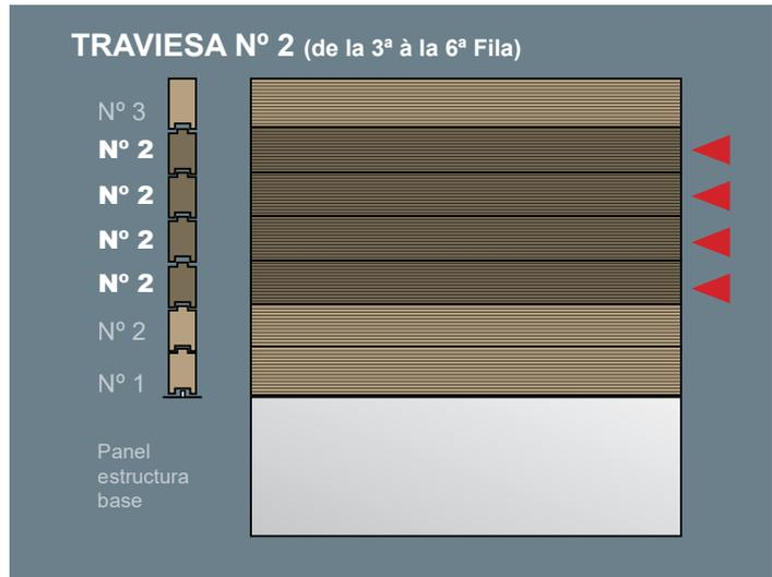
La traviesa nº 2 se destina a la construcción del muro de la piscina, desde la 2ª a la 6ª fila, con la excepción de la pared donde será instalado el equipamiento de filtración. En esta pared las traviesas irán solamente hasta la 3ª fila. Esta colocación del Skimfiltro y de la boquilla de impulsión serán abordados en los siguientes capítulos.
