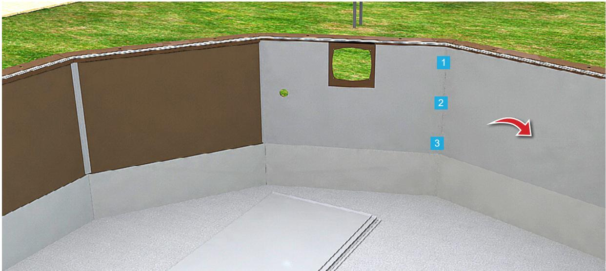
La fijación de los paneles de acero tiene inicio en la pared del skimmer.
