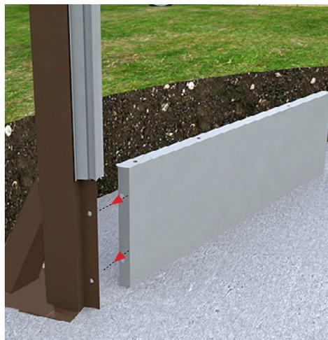
Para obtener la posición de los restantes paneles, instale primero los de la estructura.
