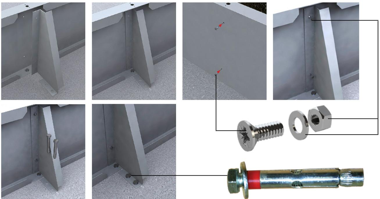
Coloque el refuerzo triangular del panel, acertandolos a través de las perforaciones existentes. Utilice los respectivos tornillos y tuercas para la fijación del panel. Para la fijación del refuerzo triangular utilice los bujes de metal que uso para la fijación del panel de estructura de base.
