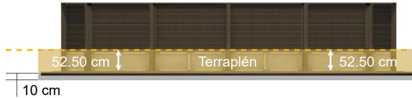
En seguida, realice un terraplén hasta que la estructura base en acero quede completamente cubierta (aproximadamente 52.50cm).
