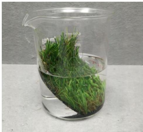
*Figura 9: Test de resistencia al cloro (Disolución con 20 mg/l).*
