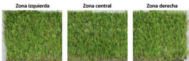
*Figura 6: Muestra ensayo abrasión.*
