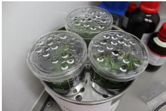
*Figura 11: Test de envejecimiento acelerado por inmersión en agua caliente.*
