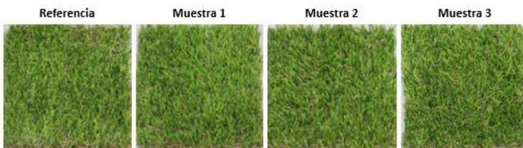
**Figura 8: Muestras test de resistencia a la humedad y a la temperatura.**
