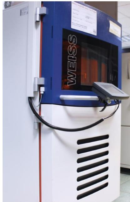
Figura 14. Cámara de choque térmico
