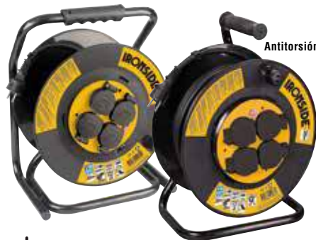
ENROLLACABLES IP44. Con protección térmica. 4 tomas con protección infantil. 3x2,5 mm 2 . 16A-230V. Potencia máxima enrollado: 1300 W. Potencia máxima totalmente desenrollado: 3600 W. IP44. 143605 25 m 82'60 + IVA = 99'95 146063 35 m 123'14 + IVA = 149'00 143606 40 m 147'93 + IVA = 179'00
